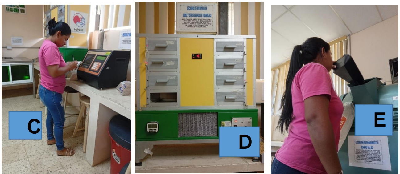
(C) Toma del porcentaje de humedad de cada muestra en el equipo Dickey Jhon GAC 2100 muestras con mayor humedad del 12% (D) secadora marca GAVIAGRO SM8B (E) Eliminación de impurezas de las muestras en el equipo cárter Day.
