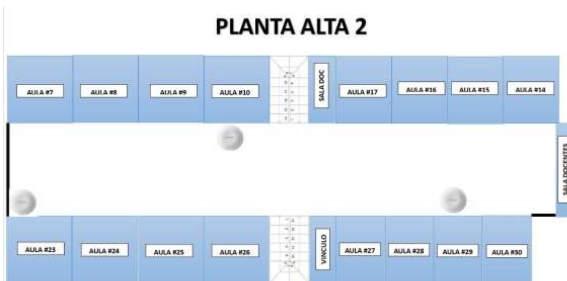
Imagen 3: Distribución de Access Points instalados en la planta alta 2 de FAFI. Fuente: El Estudiante.
