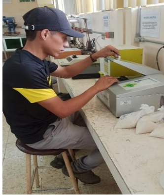
Figura 19. Análisis con precisión del porcentaje de amilosa y la proteína que contienen las muestras de arroz.
