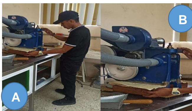
Figura 12. Obtención del grano integral para la toma de su peso (A). Descascaradora de arroz (B).
