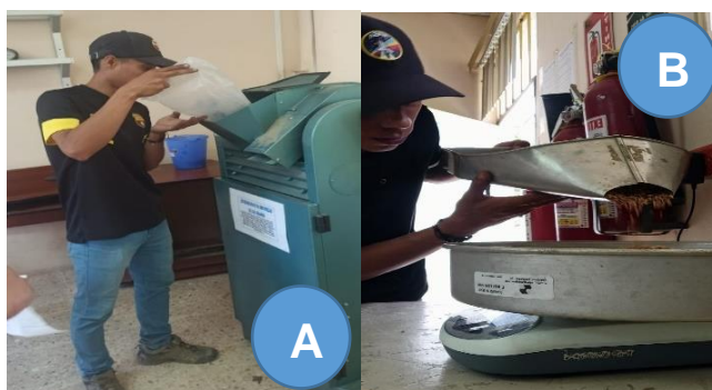
Figura 11. Eliminación de las impurezas de la muestra (A). Toma del peso del grano limpio (B).
