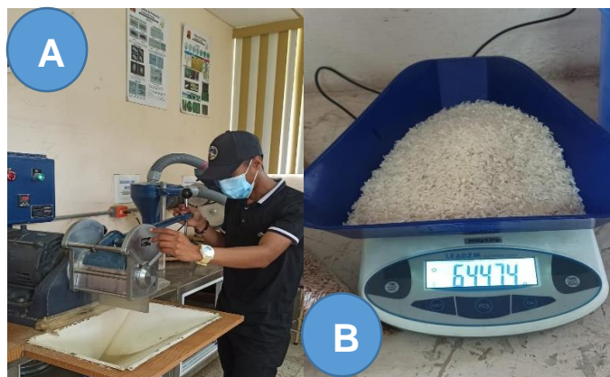
Figura 13. Proceso del pulido del grano integral en la maquina mini pulidora (A). Toma del peso de masa blanca (B).
