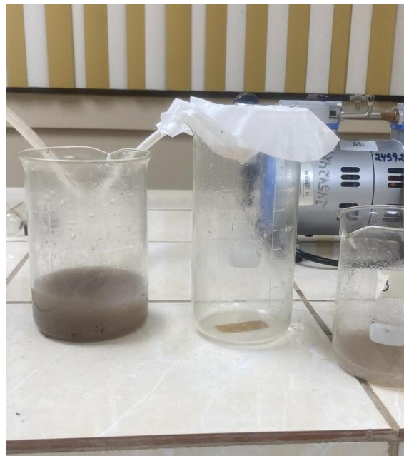
Anexo 14: Filtración de los residuos.
