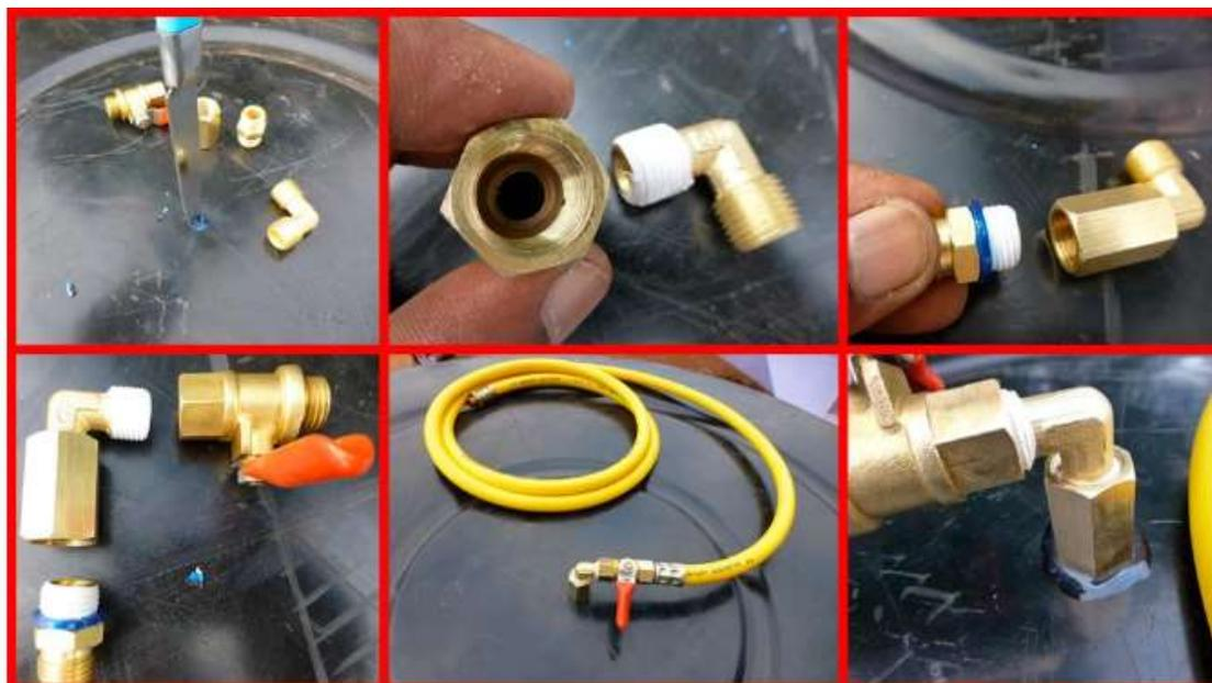
**Anexo 14:** Colocación del tubo de salida del gas en el tanque colector.
