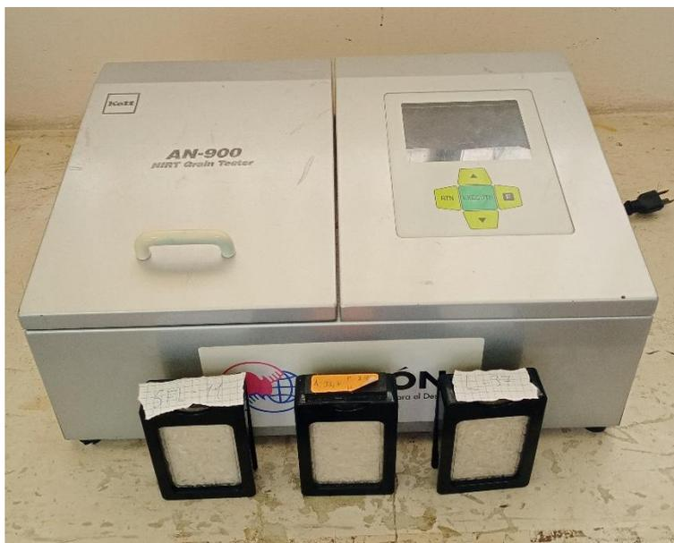
**Figura 5.** Determinador de amilosa y proteína.
