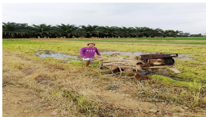
Figura 2. Preparación del terreno y posterior proceso de fangueo con un motocultor (maquinaria agrícola).
