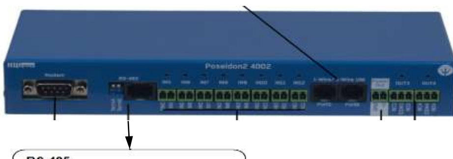
Figura 3: Equipo Poseidon Vista posterior de conexiones
