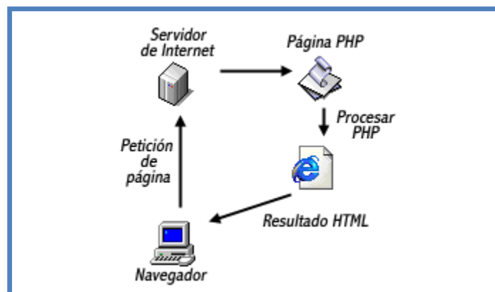
FIGURA # 2/ Proceso de ejecución de PHP en el servidor
