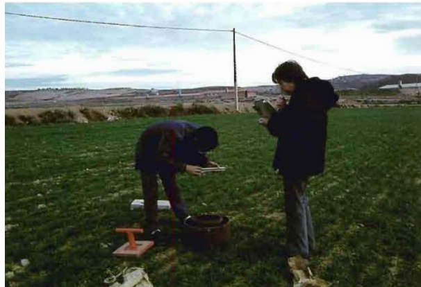
Fig. 4.- Instalación de un doble cilindro infiltrómetro para la medida de la infiltración del suelo.
