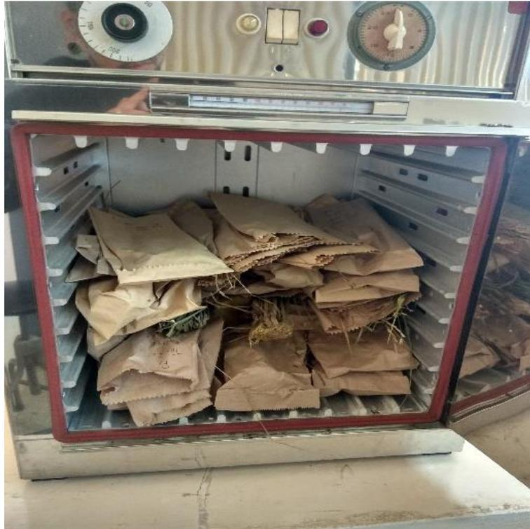
**Figura 25. Colocación de la parte aérea en la estufa para su respectivo secado.**
