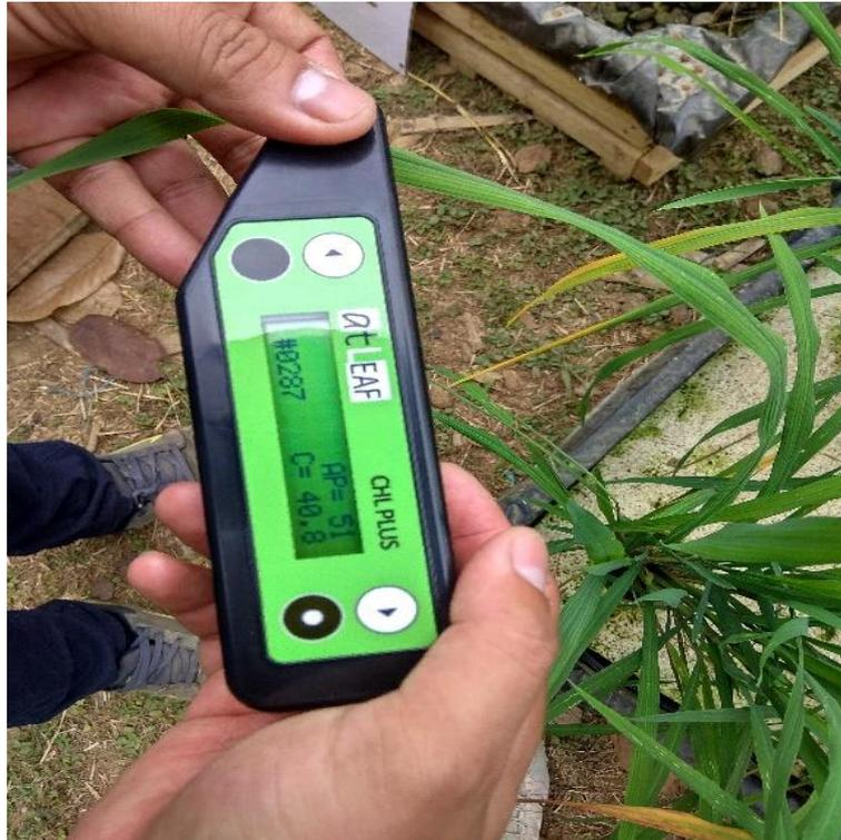
**Figura 9. Utilización del medidor de clorofila**
