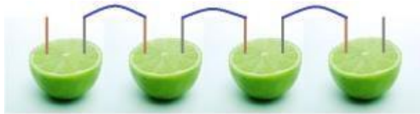
Figura # 3-2: Cuatro pilas hechas con limones, conectadas en serie.
