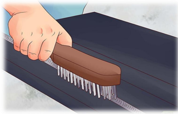
Figura # 24: Limpieza de los cordones de soldadura.
