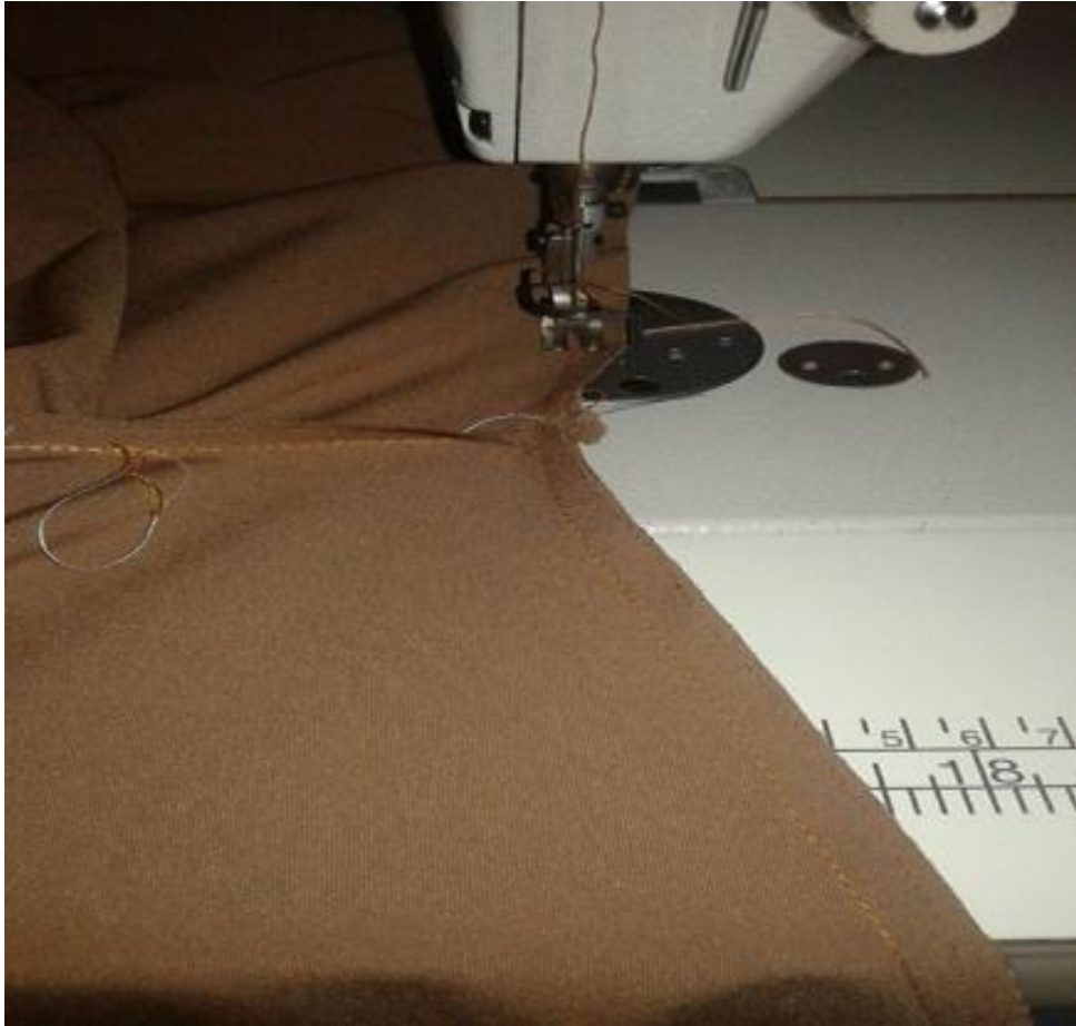
Figura 44. Confección de la entrepierna Fuente: Creación de la investigadora.
