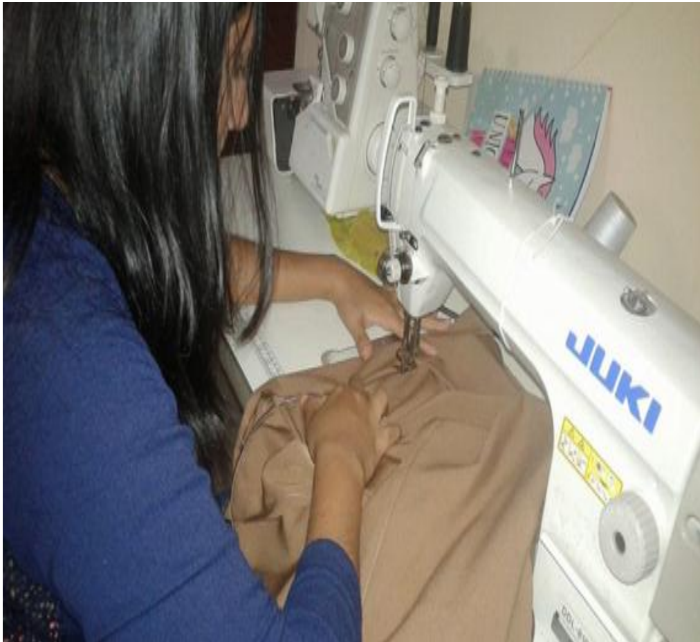
Figura 48. Confección de la pretina del pantalón Fuente: Creación de la investigadora.
