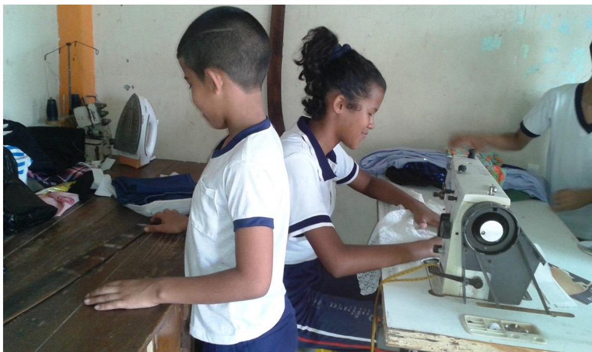
Figura 11. Grupo de estudiantes en el taller de costura. La mesa donde se hacen los trazos con los materiales necesarios para trazar el molde del bolso. Estudiante cociendo el forro del bolso de tela Denim.
