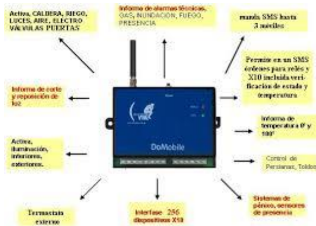
Figura 5. Controlador GSM de la Familia DoMobile: AMS-51 (Domotica Viva, 2017)
