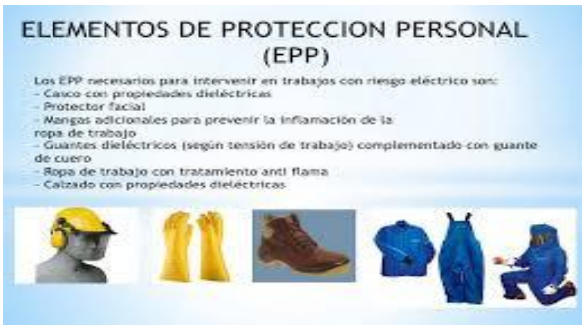
Figura: 11 Equipos de aislamientos para los riesgos eléctricos
