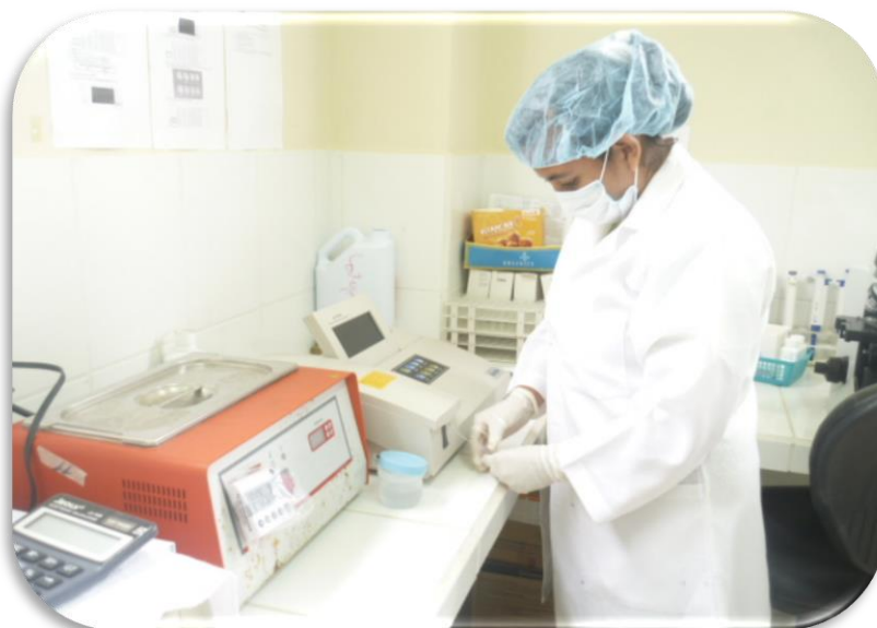
Foto 4.- Lectura de muestra en el espectrofotómetro.
