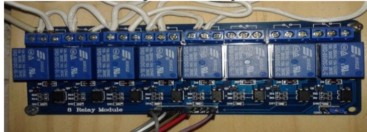
Fig. 2. Relé de 8 puertos
