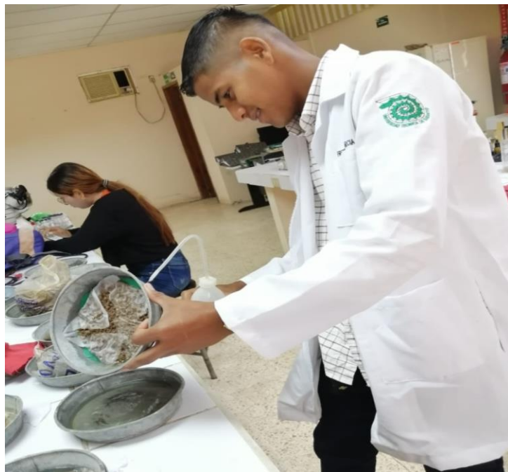
Figura 15. Lavado con bomba de presión.
