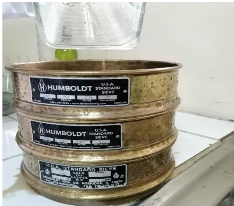
Figura 23. Colocada de tamices en orden de numeración
