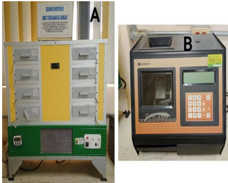
Figura 3. Secadora marca GRAVIAGRO SM8B (A); Colocar el arroz seco en cáscara al determinador de humedad (B).
