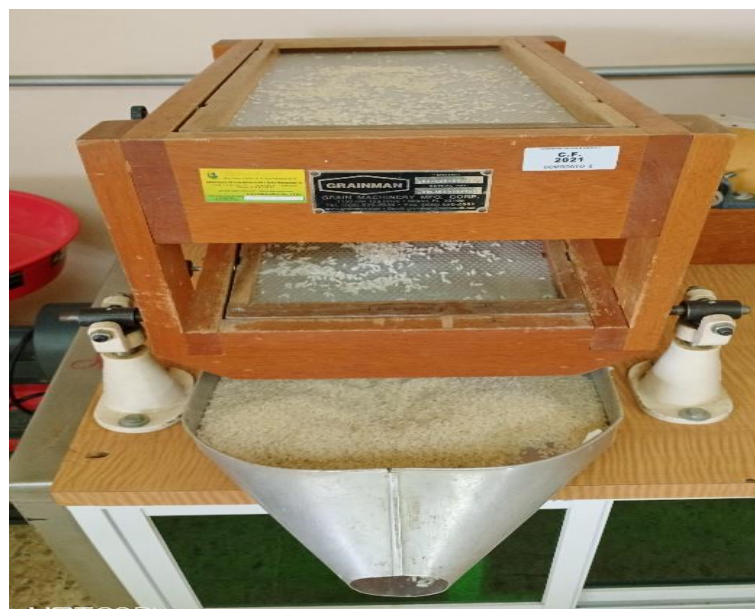
Figura 7. Proceso de clasificación del arroz en granos quebrados y granos enteros.
