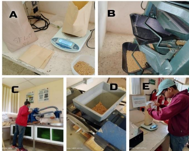
Figura 2. Proceso de obtención de peso de cascarilla. Peso de 1000 g de arroz por repetición en la balanza gramera (A); La muestra se colocó en el limpiador de grano (B); Descascarado de las muestras para sacar el grano integral (C y D); y pesado del grano integral.
