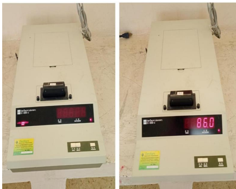
Figura 9. Determinador de blancura del grano. En pantalla se muestra el valor del estándar.
