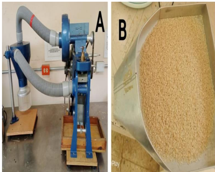
Figura 4. Descascarado de los 1000 g de arroz (A); Arroz integral (B).
