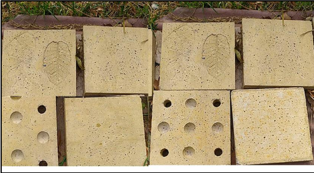
Figura 1. Ladrillos elaborados a base de cáscara de café
