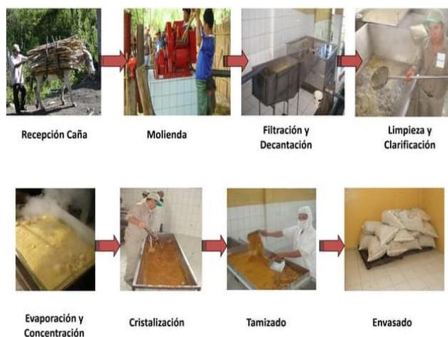
*Ilustración 4 Proceso de elaboración de la panela artesanal*
