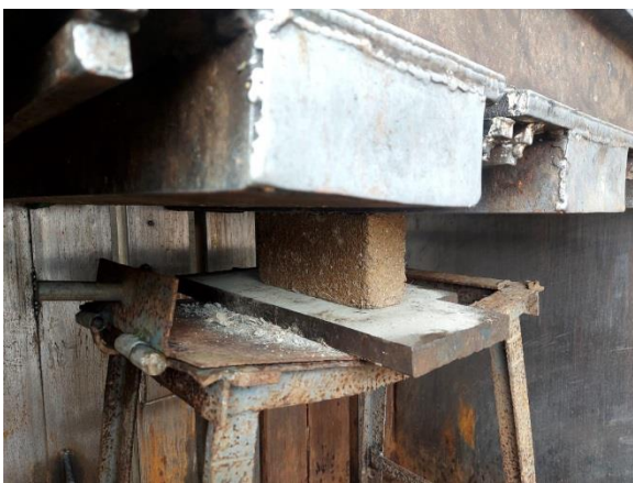
Ilustración 15: Prototipo #3 45% F.coco inicio del análisis de resistencia
