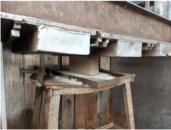
Ilustración 13: Prototipo #2 35 % F.coco inicio del análisis de resistencia.
