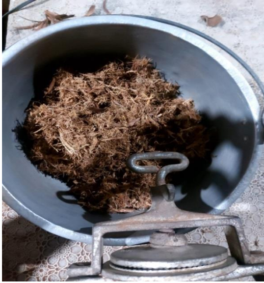
Ilustración 6: Fibra triturada con longitud de 5mm
