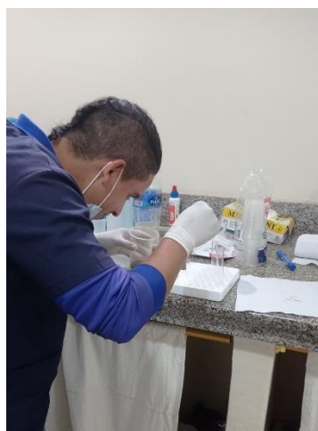
Ilustración 11 colocación del cubre objeto, sobre el tubo de ensayo con la muestra ya disuelta
