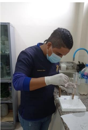
Ilustración 12 colocación de la muestra diluida dentro del tubo de ensayo
