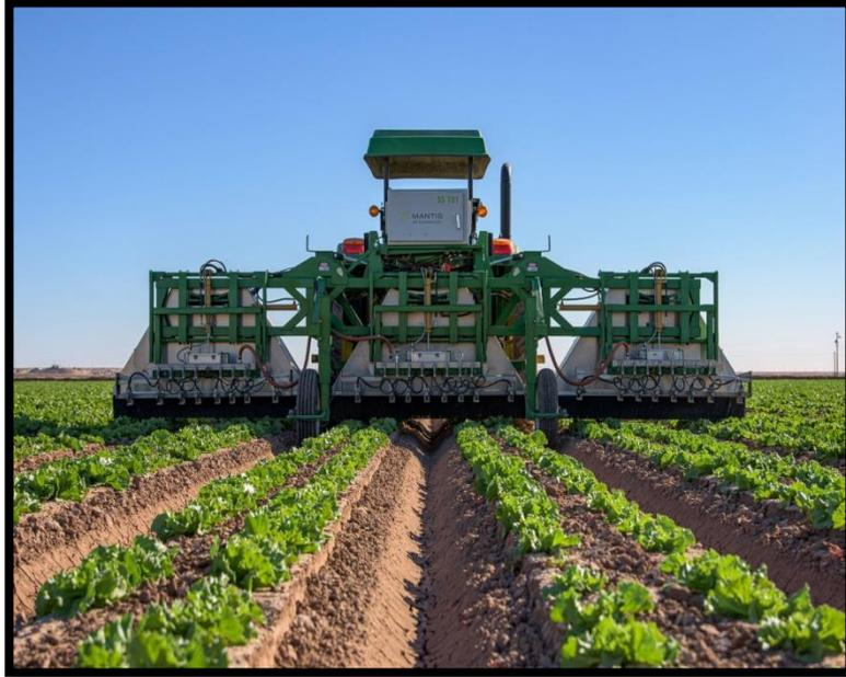
**Figura 5.** Pulverizadores autónomos
