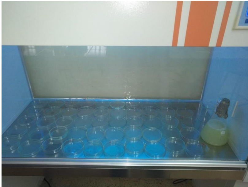
Figura 19. Siembra de microorganismos dentro de la cámara de flujo laminar
