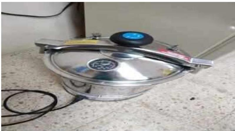
**Fotografía 5:** Autoclave, marca FOINE, modelo YX-16HDD, serie 215-09242, se la utilizo para la esterilización del agua destilada.
