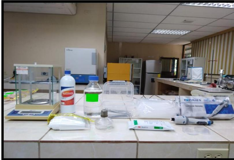
**Fotografía 6:** Balanza digital de la marca RADWAG, modelo WLC2A2, serie 559147, alcohol al 90%, agua destilada, equipo de disección, puntas para pipetas 10 ml, micropipeta de la marca TOPSCIEN modelo 8011388, serie S10M80409010, bolsas estériles, mechero de bunsen,
