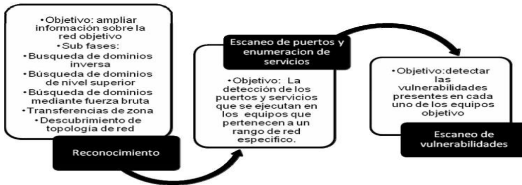
Figura1. Esquema de la metodología para la detección de vulnerabilidades en redes de datos.
