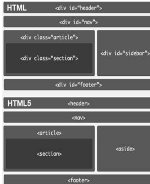
Figura 2.11. Estructura de HTML5
