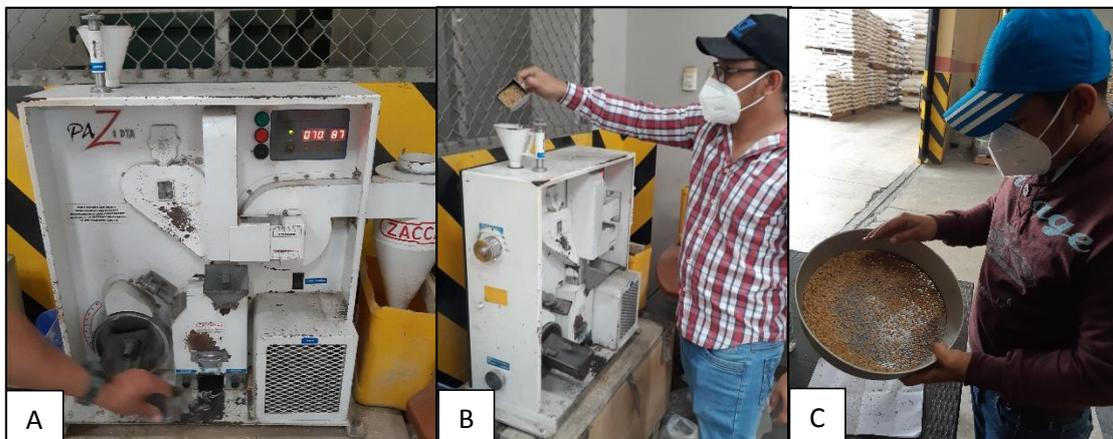
**Figura 11.-**Descascaradora marca Zaccaria (A). Procesamiento de muestras (B). Evaluación de variable impurezas y grano limpio (C).
