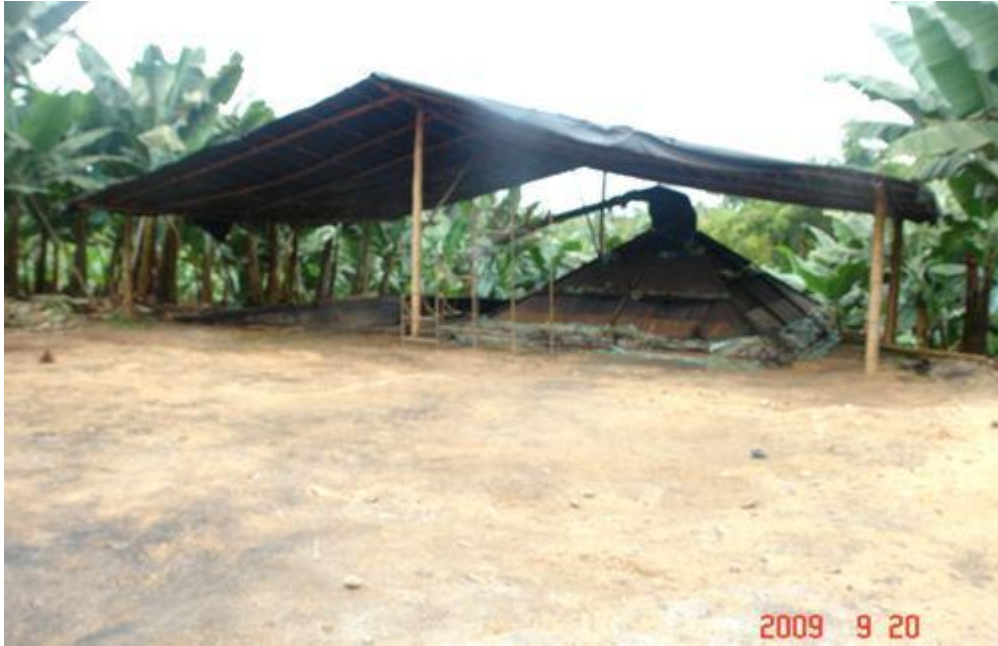
Modelo de construcción y funcionamiento de un horno para extracción de silicio orgánico a través de la cascarilla de arroz ( Oryza sativa ). Quevedo, 2009.
