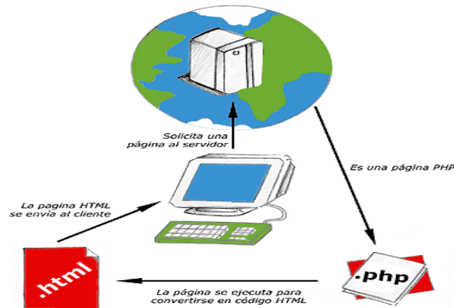
Figura 13. Esquema del funcionamiento de las páginas PHP
